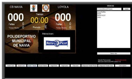
A la derecha de la pantalla se sitúa el área de control, con los botones para las diferentes acciones, así como en la parte inferior. Tanto durante el partido como en la preparación del videomarcador en los instantes previos al encuentro. A través del videoprocessador conseguimos que en la pantalla se vea el videomarcador únicamente y se omitan los mandos que si pueden verse en el PC.
